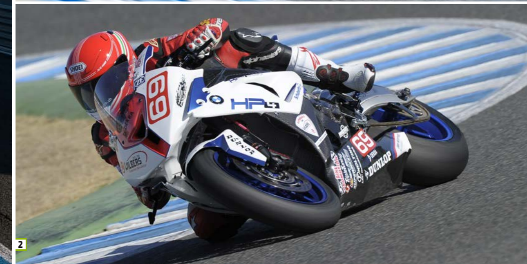
1. Langstrecken-Renner des Team penz13.com: straff abgestimmt, frontlastige Gewichtsverteilung, Reihenvierzylinder mit viel Knall oben. 2. Lucy Glöckners IDM-SST-Bike: Die einzige HP4 und das einzige Bike mit Dunlops (alle anderen auf Pirelli). Glöckner wurde heuer IDM-Zweite .
